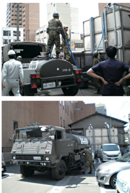
■図4 受水タンクに給水している様子 (熊本市嶋田病院)
