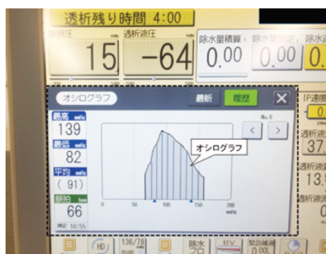
図2 コンソールパネル上のオシログラフ 当院では、オシロメトリック法による血圧測定のプロセスで生じるオシログラフをコンソールパネル上に表示し、グラフの形状および平均血圧の変化を透析中の全身管理に役立てている。
